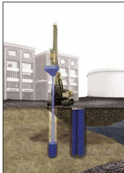
El empleo de estas columnas supone el incremento del ángulo de rozamiento interno y del módulo de deformación del terreno.
